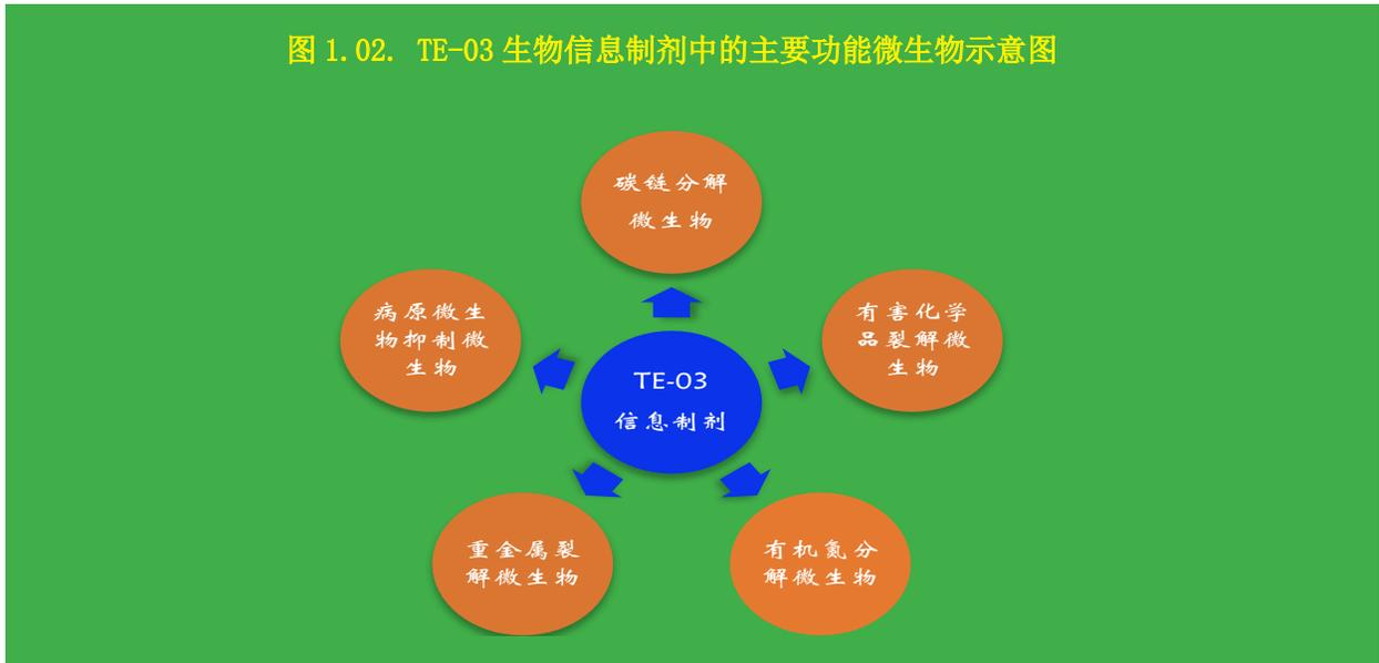
由图 1.02 所示，TE-03 生物信息制剂主要的功能微生物有五大类。这五大类功能微生物相互协调构建出根治底泥污染物质的生态自循环系统。
