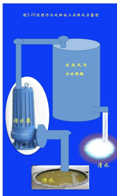
图 5.01 所示的是三安农村自流式污水处理模式。所谓三安模式是指农村污水处理建设环境简易、安全（不需要动用大型工程）、污水处理的过程安全（没有污泥、臭气等二次污染）、治理的效果安全（治理后的水用于景观或者二次应用）。
